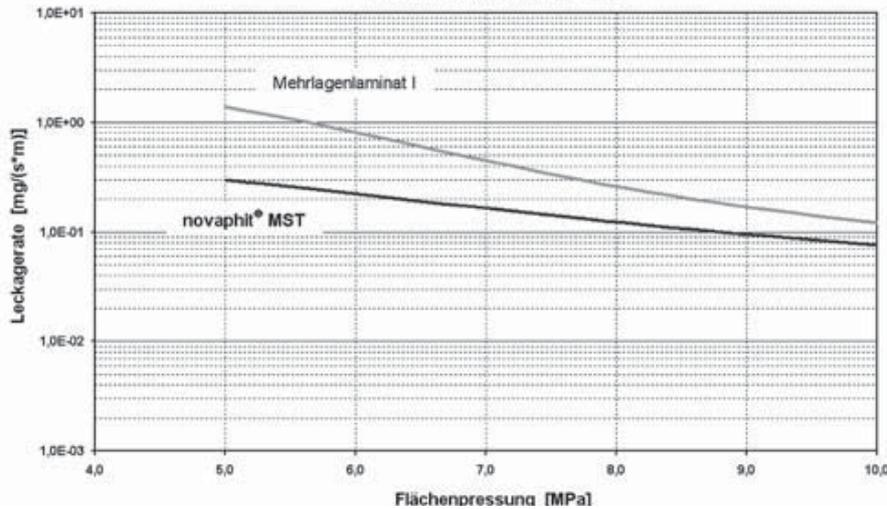
**>>4: Leckageverhalten von TA Luft-konformen Mehrlagenlaminaten, Dicke 3 mm**
